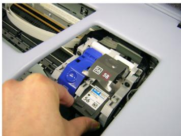
*Ilustração da instalação do cartucho.*
